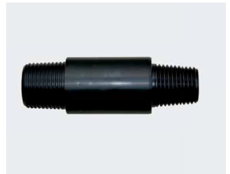
Adapter | Adaptor konisches Trapezgewinde Ø 95 mm (z. B. Nordmeyer) auf API 2 3/8" IF, weitere Gewinde auf Anfrage conic trapezoidal thread Ø 95 mm (e. g. Nordmeyer) to API 2 3/8" IF, other threads on request
